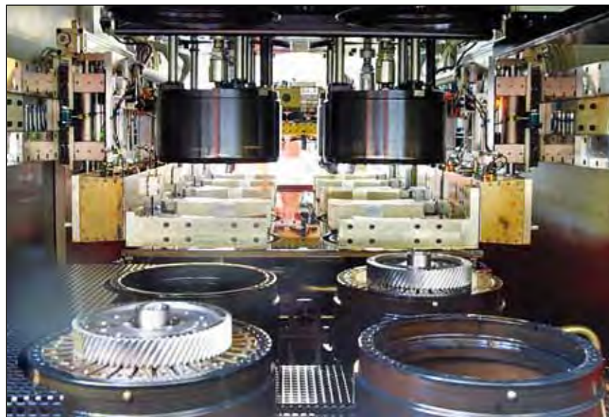
Bauteiltransport in einer Fixturhärtemaschine
